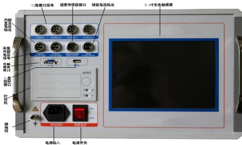
**12路断口信号：**测量12个主触头、6个主触头和6个辅助触头的合（分）闸时间、不同期、弹跳时间、弹跳次数等参数。
