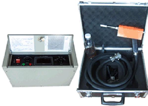
**设备名称：** 高精度 SF6 定量检漏仪
